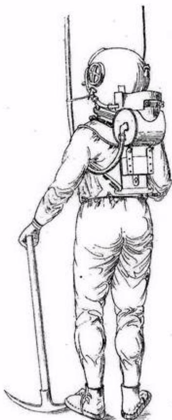
Dessin d'un scaphandrier équipé du régulateur de pression Rouquayrol-Denayrouze en position dorsale
